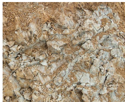
图 1 试验地点强膨胀土
